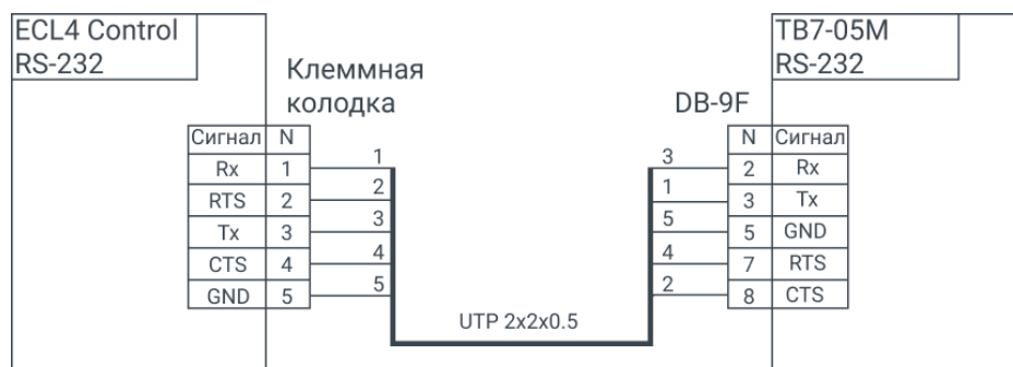
Рис.22. Схема подключения тепловычислителя ТВ7 к ECL4 Control 368 Ethernet.
