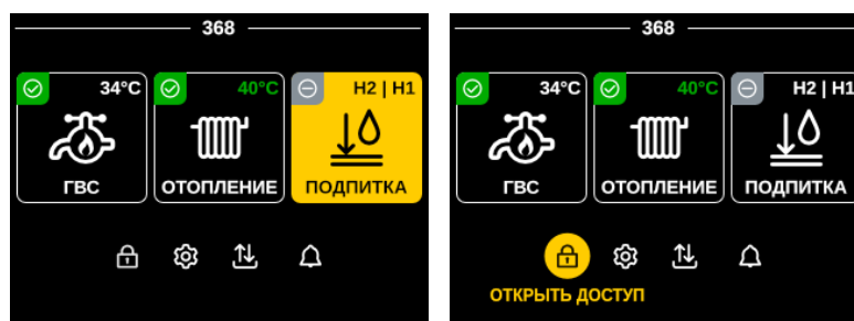
Рис.6. Главный экран ECL4 Control 368 с активной навигацией в области модулей автоматики (слева) и в области общего меню (справа).
