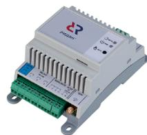
Модем имеет встроенные интерфейсы GSM и Ethernet для передачи данных в Cloud Control.
