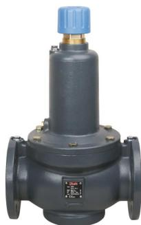
Клапаны балансировочные тип АРФ далее – клапан АРФ) - регуляторы постоянства перепада давлений, предназначенные для гидравлической балансировки трубопроводных систем тепло- и холодоснабжения при переменных расходах проходящей через них среды в диапазоне от 0 до 100% (Рис.1).
