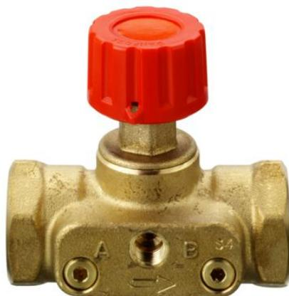
Клапан запорный типа CDT (далее – CDT) предназначен для установки на подающем трубопроводе. Может быть использован только в качестве запорной арматуры и для присоединения импульсной трубки от клапанов балансировочных АРТ или ASV-Р. Клапан поставляется с заглушками под измерительные ниппели. При установке ниппелей возможно измерение расхода теплоносителя, протекающего через данный участок системы.
