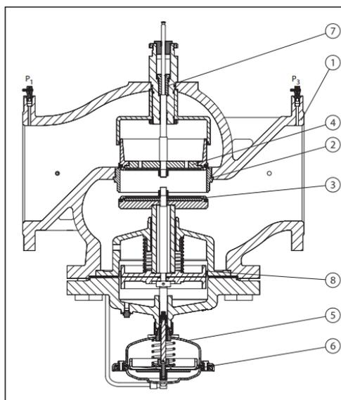
Устройство AQF Ду 200, 250: 1 — корпус клапана; 2 — седло клапана; 3 — конус регулятора перепада давлений; 4 — конус регулирующего клапана; 5 — корпус регулирующей диафрагмы; 6 — диафрагма; 7 — винт настройки; 8 — сифон разгрузки давления.
