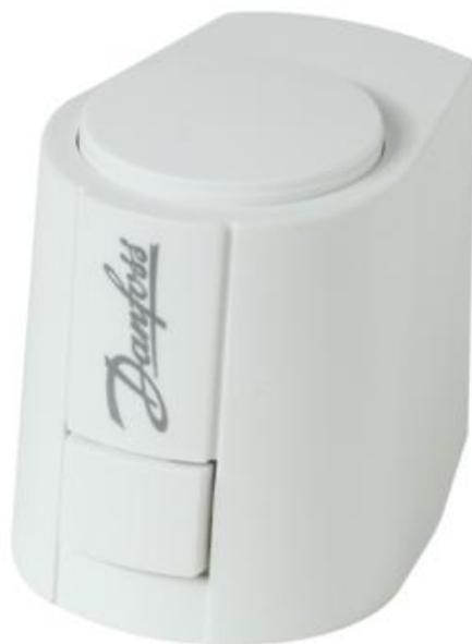
Привод термоэлектрический типа ABNM (далее – ABNM) А5 специально разработан для применения с клапанами балансировочными типа АВ-QM Ду 10-32 в системах отопления и охлаждения, управляется сигналом 0-10 В.
