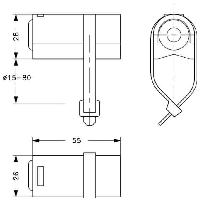
Габаритные размеры датчика температуры типа ESM-11
