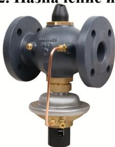
Клапан-регулятор давления типа AVPQ является регулятором прямого действия для поддержания постоянного перепада давлений с автоматическим ограничением предельного расхода теплоносителя.
