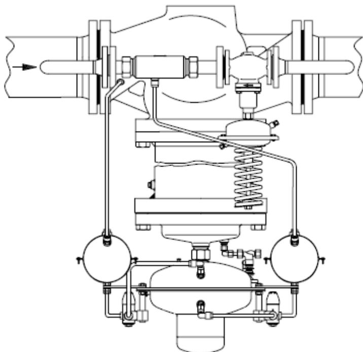
Клапан регулирующий типа PCV состоит из проходного клапана с управляющей диафрагмой, установленного на основную трубу, а также вспомогательного клапана DN40 и дроссельного элемента, установленных на байпасе.
