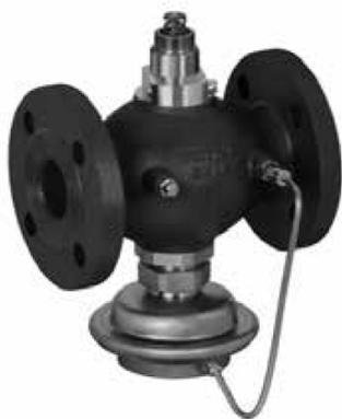
Клапан регулирующий типа AVQM модификации AVQM-F (далее- клапан регулирующий AVQM-F) используется совместно с электроприводами типа ARV(E) 152, AMV(E) 23, AMV(E) 23SU, ARV(E) 153 и AMV(E) 33, которые управляются электронными регуляторами Danfoss серии ECL. В соответствии с требованиями DIN 32730 в системах теплоснабжения следует отдавать предпочтение комбинациям AVQM и приводов с возвратной пружиной типа AMV(E) 23 и AMV(E) 33.
