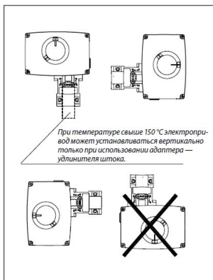
Примечание. При температуре теплоносителя свыше 150 °С электропривод без адаптера – удлинителя штока должен устанавливаться на клапан только горизонтально.
