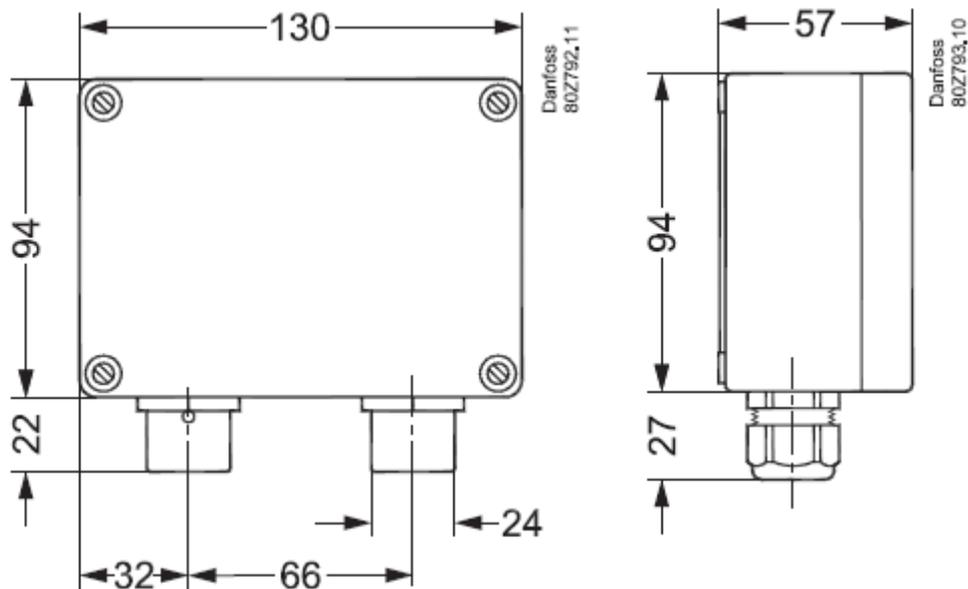
*Рис. 2 Габаритные размеры детектора газа типа DGS, IP65*
