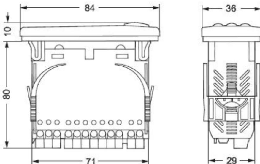
Рис. 3 Габаритные размеры контроллеров типа ЕКС,
