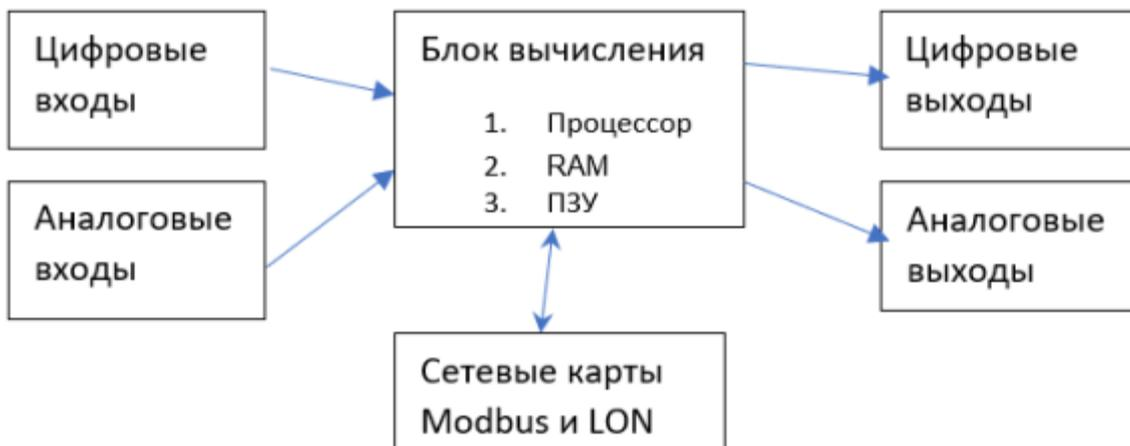
Рис. 2 Блок-схема контроллера
