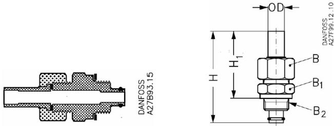
ICV 50 корпус клапана с различными соединениями
