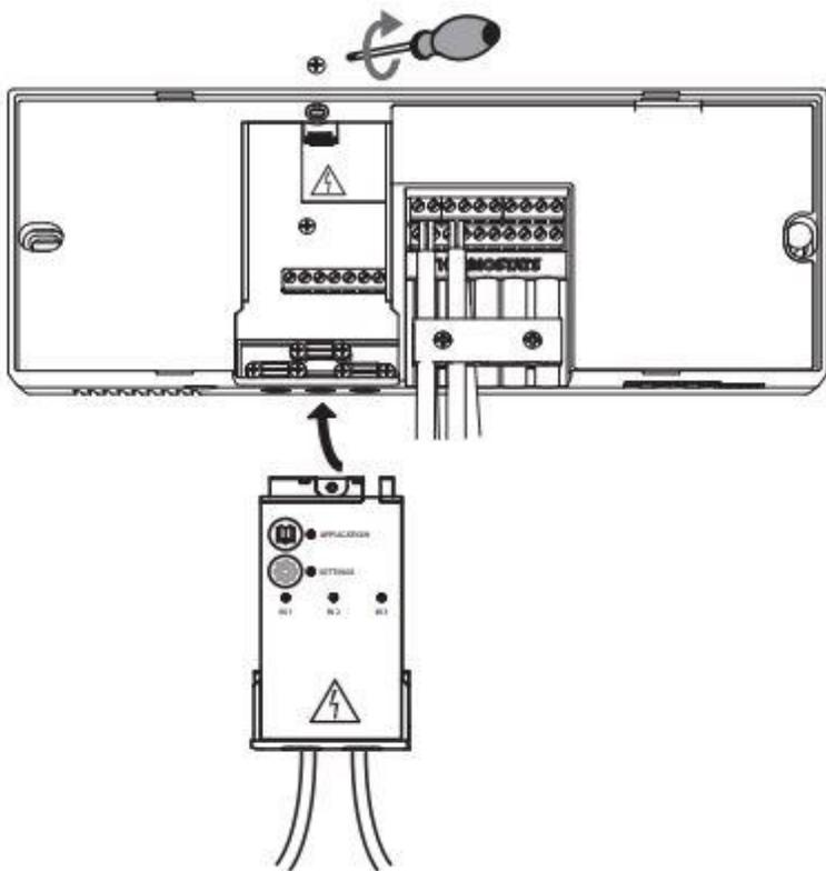
И включить Icom Master Controller в электрическую сеть
