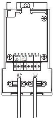
После этого установить Icom Expansion Module в корпус Icom Master Controller и зафиксировать винтом
