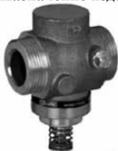
Клапан регулирующий типа VGU - разгруженный по давлению, нормально закрытый регулирующий проходной клапан. Разработан для комбинации: с электрическими редукторными приводами типов AMV(E) 20, AMV(E) 30, AMV(E) 23, AMV(E) 23SU, AMV(E) 33; с регуляторами температуры типа AVT.
