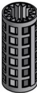
Фильтрующий элемент с гофрированной поверхностью
