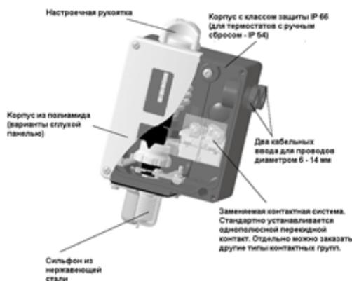
При снижении температуры до установленного значения контакты 1-2 замыкаются, а контакты 1-4 размыкаются (рис.3.2. позиция I). Контакты 1-4 замкнутся, а контакты 1-2 разомкнутся при температуре выше установленного значения плюс дифференциал (рис.3.2. позиция II).
