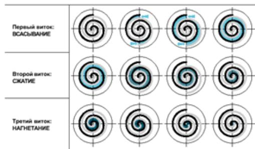
В компрессоре сжатие газа производится двумя элементами, имеющими форму спиралей, которые
