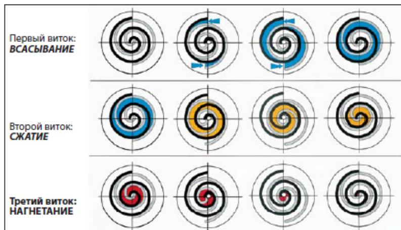
В компрессоре сжатие газа производится двумя элементами, имеющими форму спиралей, которые расположены в верхней части компрессора над электродвигателем (см. рисунок вверху). Всасываемый газ поступает в компрессор через всасывающий патрубок, обтекает кожух электродвигателя и входит в
