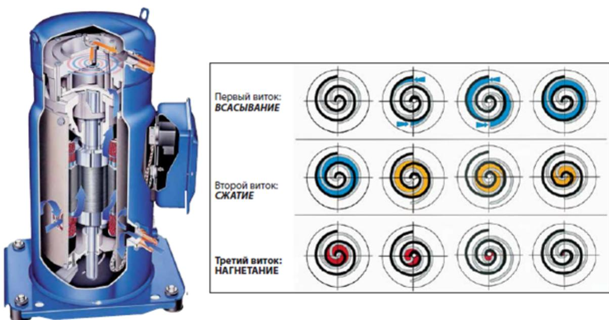
В компрессоре сжатие газа производится двумя элементами, имеющими форму спиралей, которые расположены в верхней части компрессора над электродвигателем (см. рисунок вверху). Всасываемый газ поступает в компрессор через всасывающий патрубок, обтекает кожух электродвигателя и входит в
