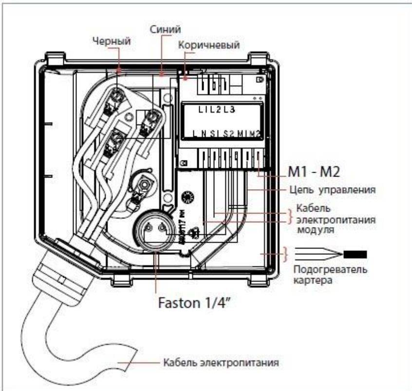
Компрессор поступает с завода с блоком защиты электродвигателя, установленным в клеммную коробку. В составе блока – устройство защиты от перекоса фаз и встроенный терморезистор. Блок защиты электродвигателя необходимо подключать к сети электропитания с соответствующим напряжением. Разъемы блока защиты имеют размер 1/4" типа Faston.
