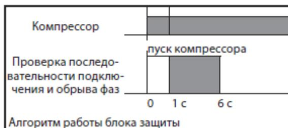
Если один из этих параметров окажется неправильным, срабатывает реле защиты (размыкаются контакты M1-M2). При этом на блоке отобразиться следующий мигающий код:
