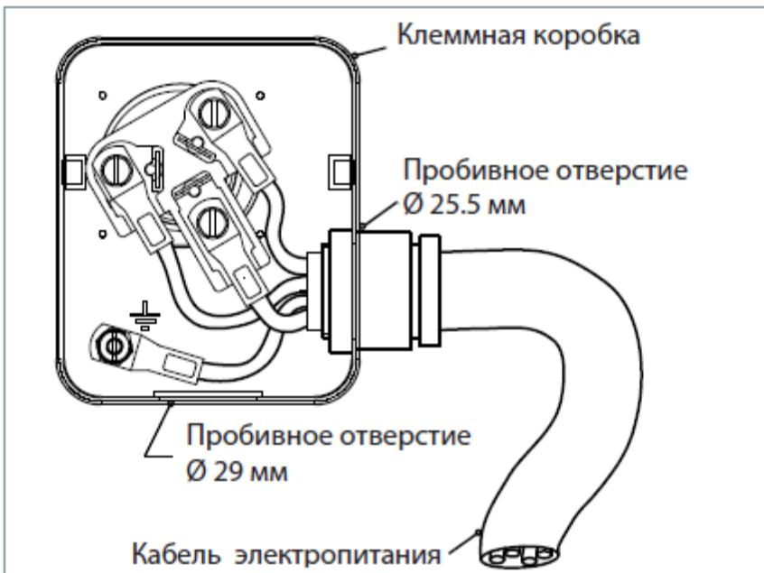
Степень защиты клеммных коробок компрессоров всех моделей составляет IP54 в соответствии со стандартом IEC529. Степень защиты действительна только в случае использования кабельных вводов правильного размера.
