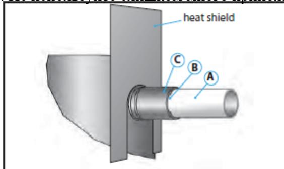
Переместите горелку на участок С, чтобы припой смог затечь в зазоры стыка. Подавайте тепло к участку С на короткое время, чтобы припой не попасть в компрессор.
