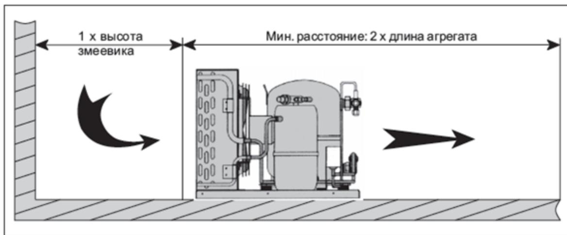
Агрегат компрессорно-конденсаторный должен быть установлен на ровную горизонтальную поверхность с углом наклона не более 3°.
