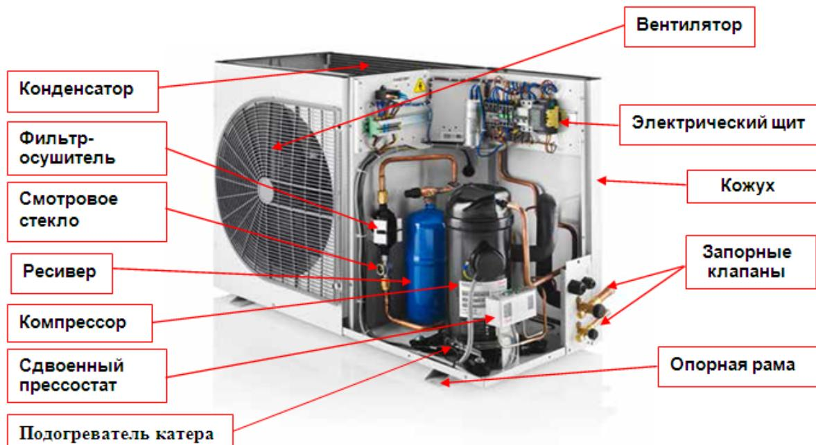
Агрегат компрессорно-конденсаторный является частью холодильной установки.
