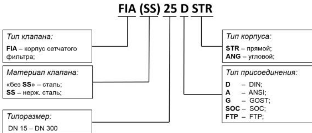
Рис. 3 Пример схемы обозначение FIA
