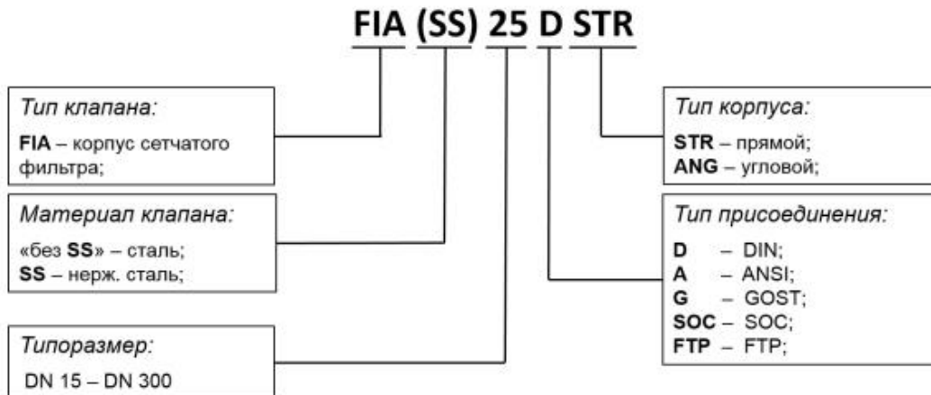
Рис. 3 Пример схемы обозначение FIA
