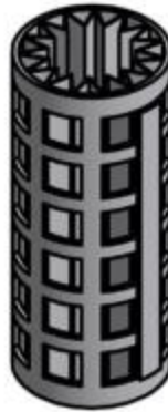
Фильтрующий элемент с гофрированной поверхностью
