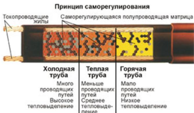
Рис. 3. Принцип работы саморегулирующейся тепловыделяющей матрицы.
