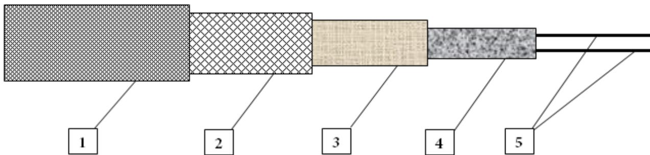
Рис. 2. Устройство нагревательного кабеля DEVIpipeguard™ 25 (Т).
