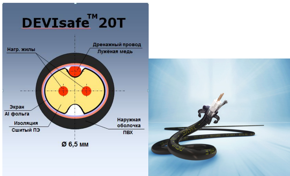
Рис. 2. Устройство нагревательного кабеля DEVIsafe™ 20T .
