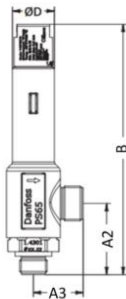
Рис. 2 Условные обозначения геометрических параметров
