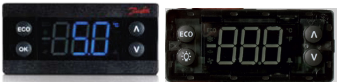
Рисунок 1 – Общий вид контроллера температуры типа ERC
