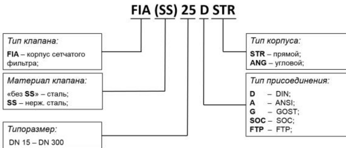
Рис. 3 Пример схемы обозначение FIA
