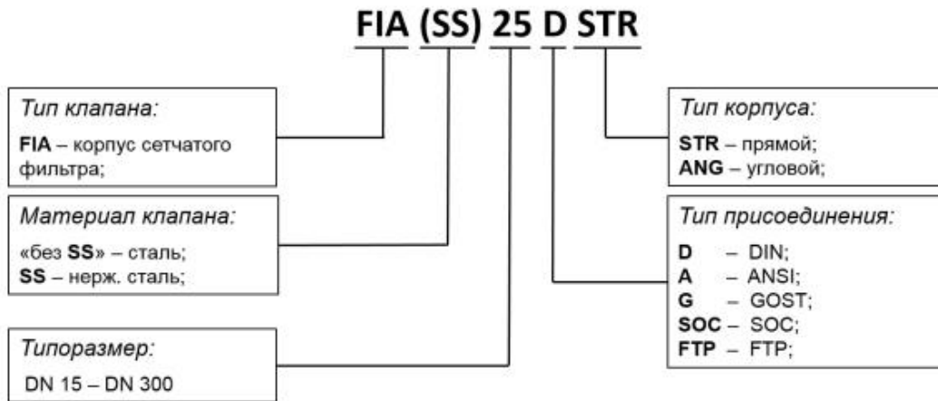
Рис. 3 Пример схемы обозначение FIA
