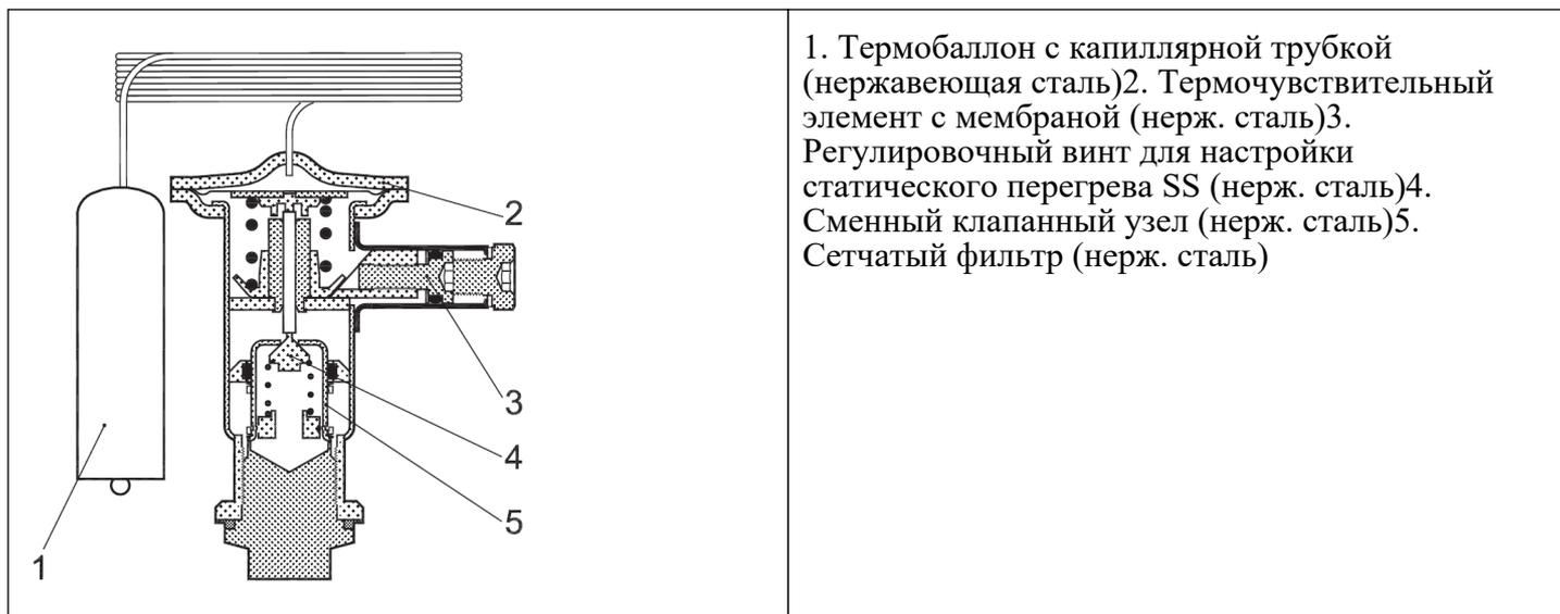
1. Термобаллон с капиллярной трубкой (нержавеющая сталь)
