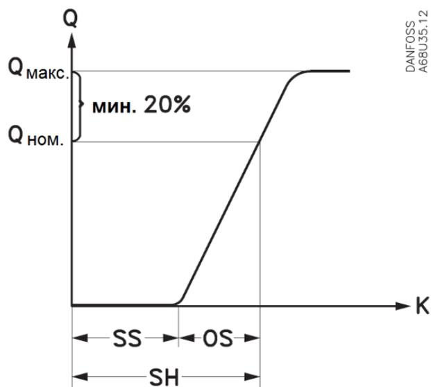
SS - статический перегрев (перегрев начала открытия клапана),
