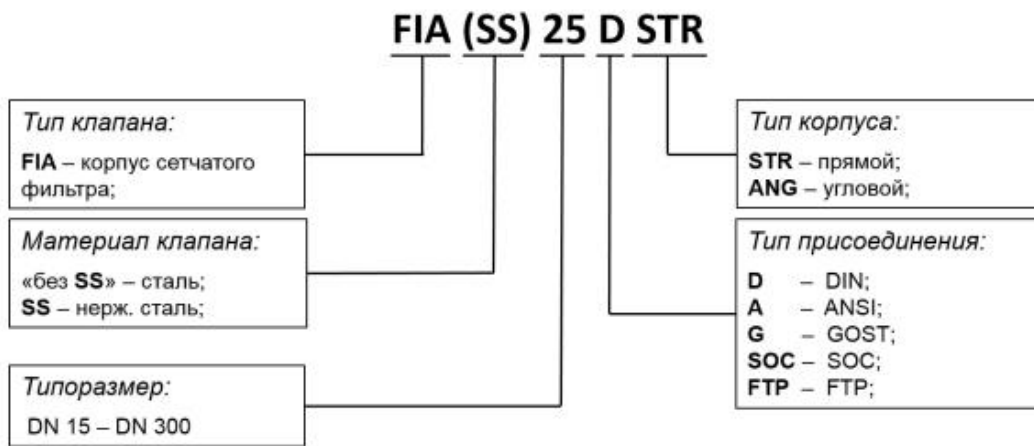
Рис. 3 Пример схемы обозначение FIA
