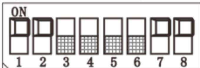
Управляющий сигнал 2-10В/Выходной сигнал 2-10В
