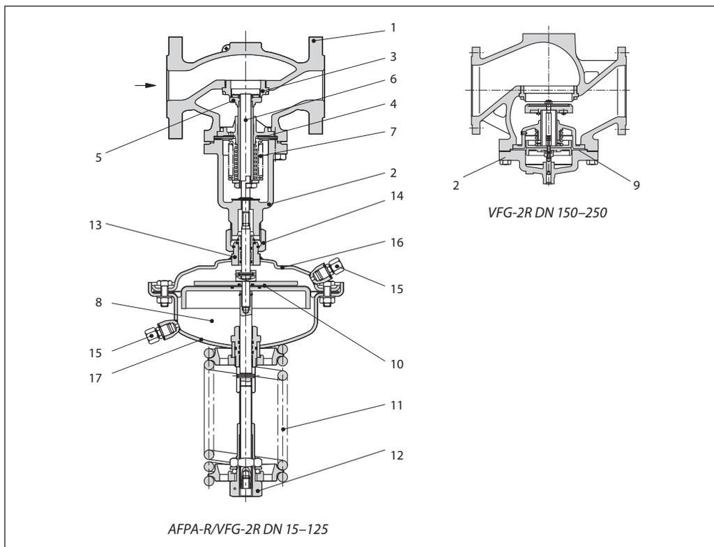
Давление в трубопроводе до и после регулятора передается в камеры над и под мембраной через импульсные трубки. При возрастании перепада давлений свыше установленного значения клапан начинает открываться
