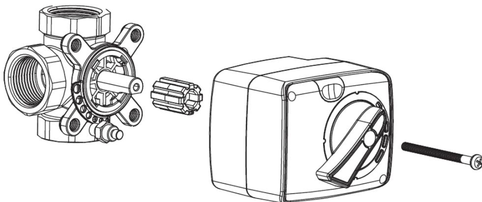
В комплекте с 3-х позиционным/аналоговым приводом поставляется монтажный комплект для клапанов HRB-3R/HFE-3R
