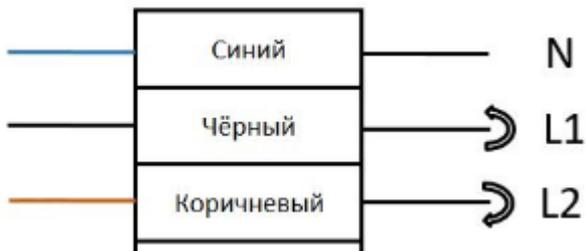
**3-х позиционный+выключатель\*:** синий - нейтраль; черный - управляющий сигнал, фаза, вращение против часовой стрелки; коричневый - управляющий сигнал, фаза, вращение по часовой стрелки; белый - фаза, вход концевого выключателя; зеленый - выход концевого выключателя "закрыт"; красный - выход концевого выключателя "открыт".
