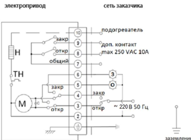
**\*Примечание:** Встроенный подогреватель контактов работает при включении привода к сети контактами 2 и 10.
