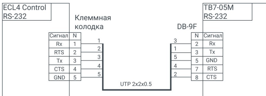
Рис.23. Схема подключения тепловычислителя ТВ7 к ECL4 Control 368R ПЧ Ethernet/Cloud.
