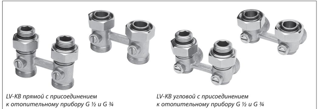
Клапан запорно-присоединительный RLV-KB применяется в двухтрубных системах отопления для подключения отопительных приборов с нижним расположением присоединительных штуцеров с межосевым расстоянием 50 мм. Клапан LV-KB не подходит для присоединения к нему спускного крана.
