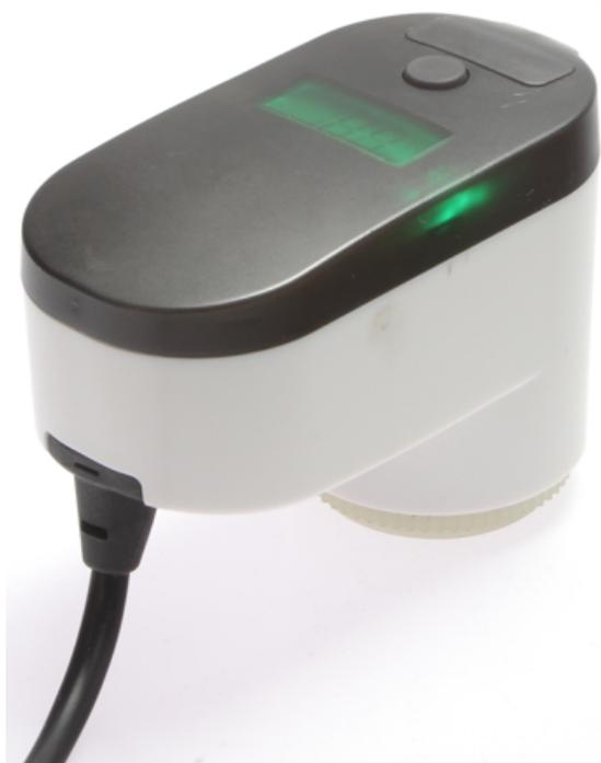
Приводы электрические АМЕ 110 NLXR предназначены для работы с клапанами балансировочными типа АQT модификации АQT-R с условным проходом 15-32 мм, управляющими подачей тепло- и холодоносителя в фэнкойлы или вентиляционные установки.
