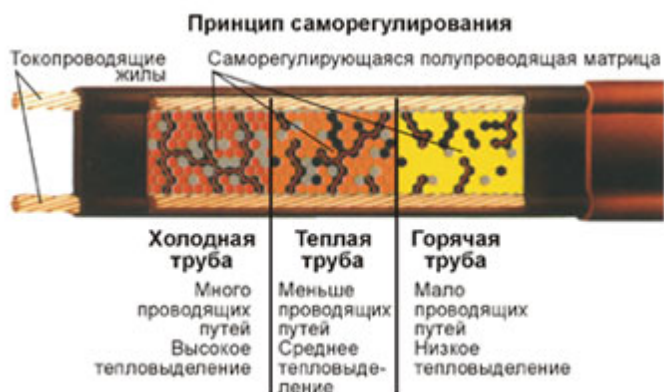
Рис. 3. Принцип работы саморегулирующейся тепловыделяющей матрицы.
