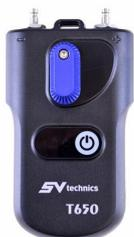
T650 предназначен для измерения перепада давлений, расхода и температуры, а также для проведения гидравлической балансировки систем тепло- и холодоснабжения и ГВС.
