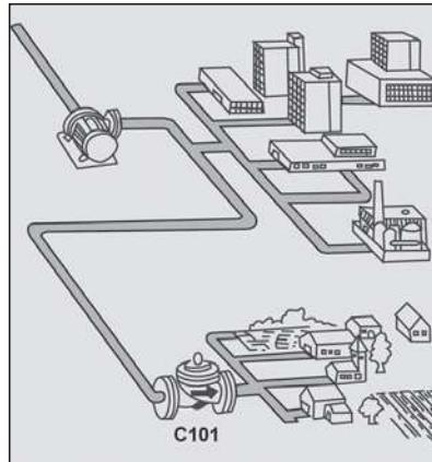
Регулятор давления С101-Р уменьшает и поддерживает постоянное пониженное давление «после себя» независимо от изменения давления до регулятора и водоразбора после него.
