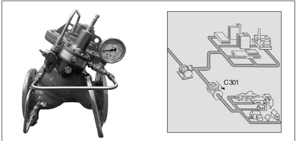
Регулятор давления С301-R предназначен для регулирования и поддержания давления «до себя» на постоянной установленной величине независимо от колебаний давления и расхода.
