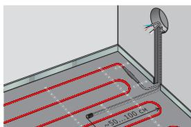
7. Установите трубку для датчика температуры пола (она должна быть заглушена на конце, во избежание попадания раствора внутрь). Проверьте сопротивление датчика перед установкой в трубку и после установки.
