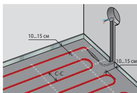
6. Проверьте значение сопротивления нагревательных жил и изоляции кабеля. Установите нагревательный кабель с отступом 10-15 см от стен, стационарной мебели, сантехники. Выбор шага укладки кабеля осуществляется при проектировании системы и уточняется при монтаже (он равен обогреваемой площади в  $m^2$  деленной на длину нагревательного кабеля в м; ответ получится в м).
