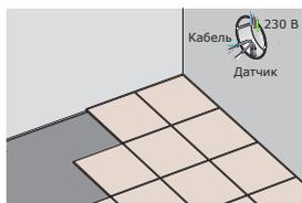
9. После необходимой выдержки стяжки проверьте значение сопротивления кабеля и его изоляции и сопротивление датчика. Уложите напольное покрытие.
