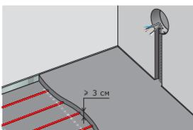
8. Еще раз проверьте значение сопротивления кабеля и его изоляции и датчика. Залейте стяжку пола (бетон или ЦПС).
