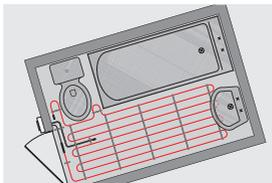
2. Начертите в масштабе схему с раскладкой нагревательного кабеля на обогреваемой площади, расположением соединительного кабеля и датчика температуры пола. Сделайте привязки к характерным элементам конструкции помещения и выбранному месту расположения терморегулятора.
