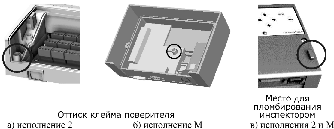
Рисунок 2 - Схема пломбировки тепловычислителя
