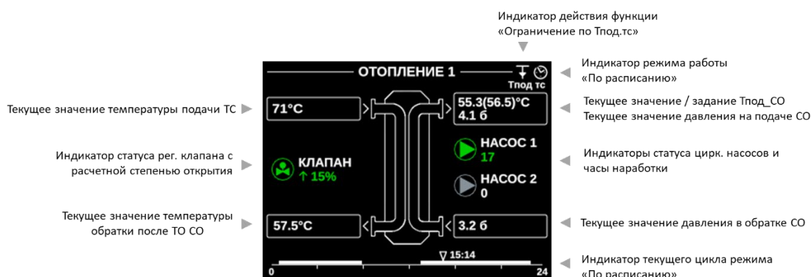
Рис.8. Мнемосхема модуля Отопление. Пример первого контура (Отопление 1).
