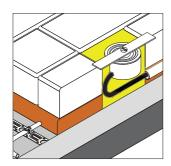
Монтаж датчика грунта выполняется совместно с монтажом нагревательного кабеля. Для этого в месте монтажа датчика необходимо предусмотреть углубление 100x100x130 мм, к которому необходимо подвести трубку с протяжкой Ø16 мм для монтажа кабеля датчика (см. рис.).
